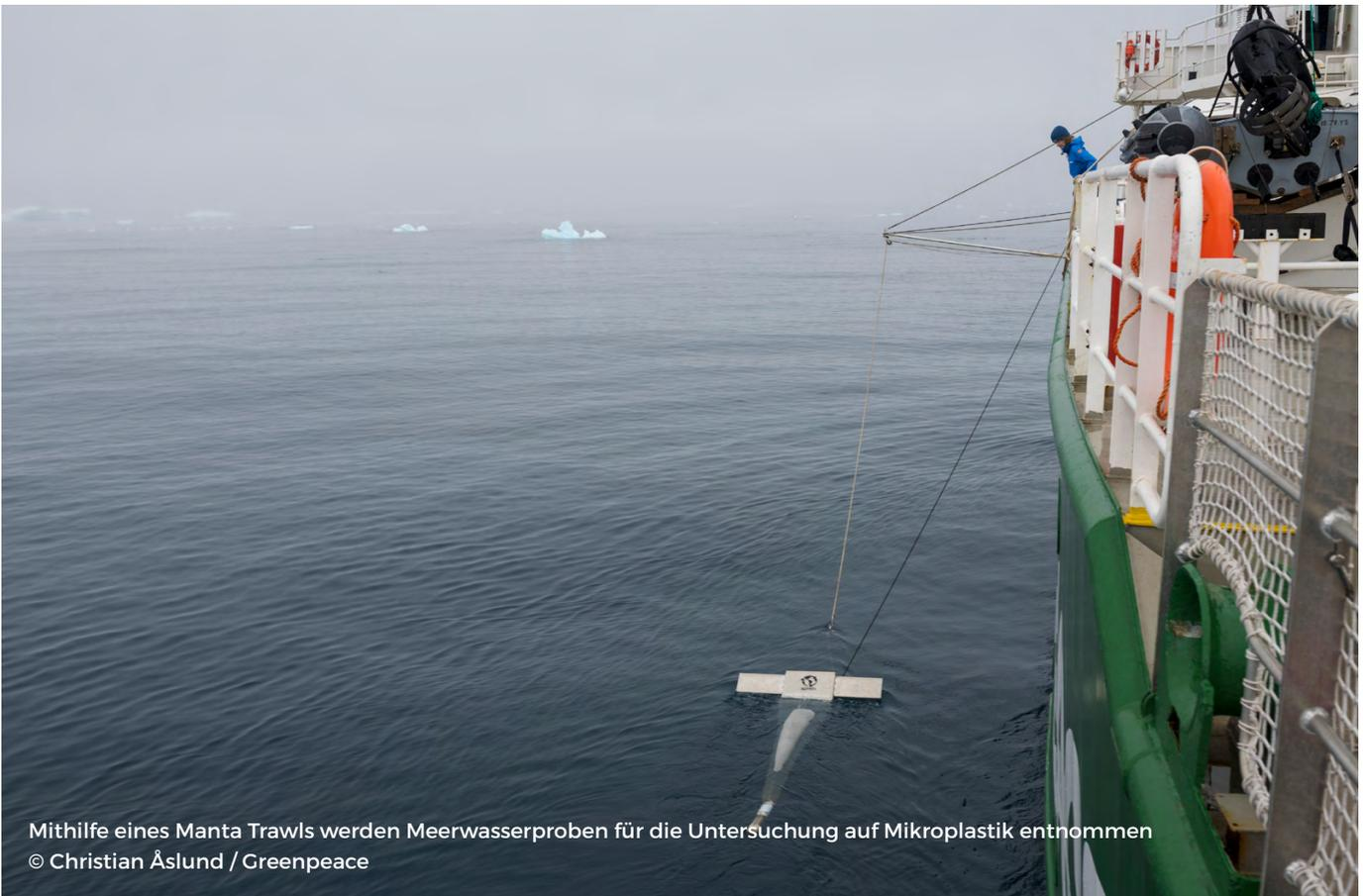
Mithilfe eines Manta Trawls werden Meerwasserproben für die Untersuchung auf Mikroplastik entnommen
