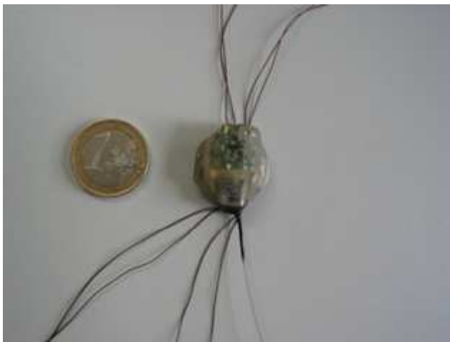
Abb. 4-4: Verwendeter VHF-Sender für Wiesenweihe (Variante mit 6,8 g und Befestigungsfäden).
